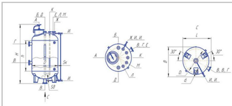
Рис 1. Вертикальный цельносварной аппарат с эллиптическим днищем (опоры-стойки)
