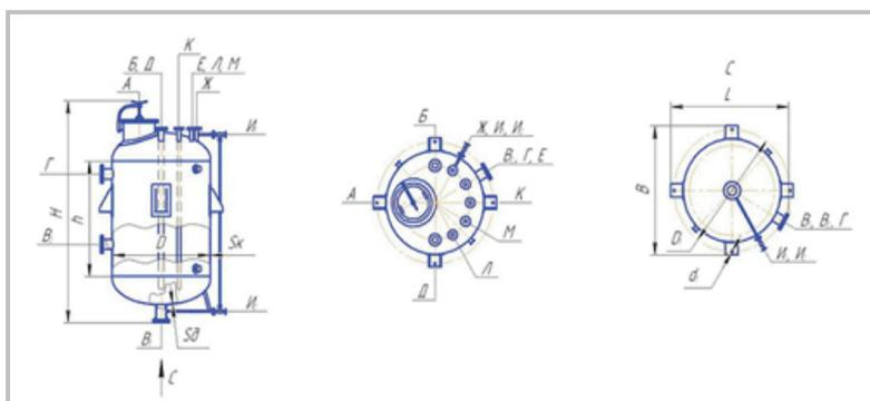
Рис 2. Вертикальный цельносварной аппарат с эллиптическим днищем (опоры-лапы)
